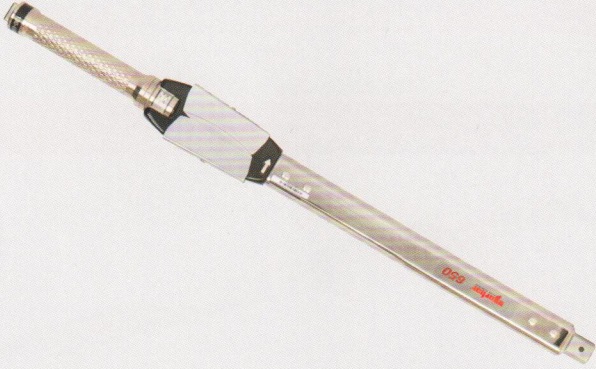
14041 ANPASSBARE INNEN-DREHMOMENTGRIFFE - DOPPELSKALA Pro 650, 14 x 18 mm, 130 - 650 N·m, 100 - 480 lbf·ft
