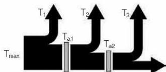
$$\begin{cases} T_1 + T_2 + T_3 < T_{max} \\ T_2 + T_3 < T_{a1} \\ T_3 < T_{a2} \end{cases}$$
