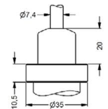
Kabelausgang, Kabel mit Belüftungsschlauch (IP 68)<sup>6</sup>
