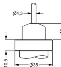
Kabelausgang mit PVC-Kabel (IP 67)<sup>5</sup>
