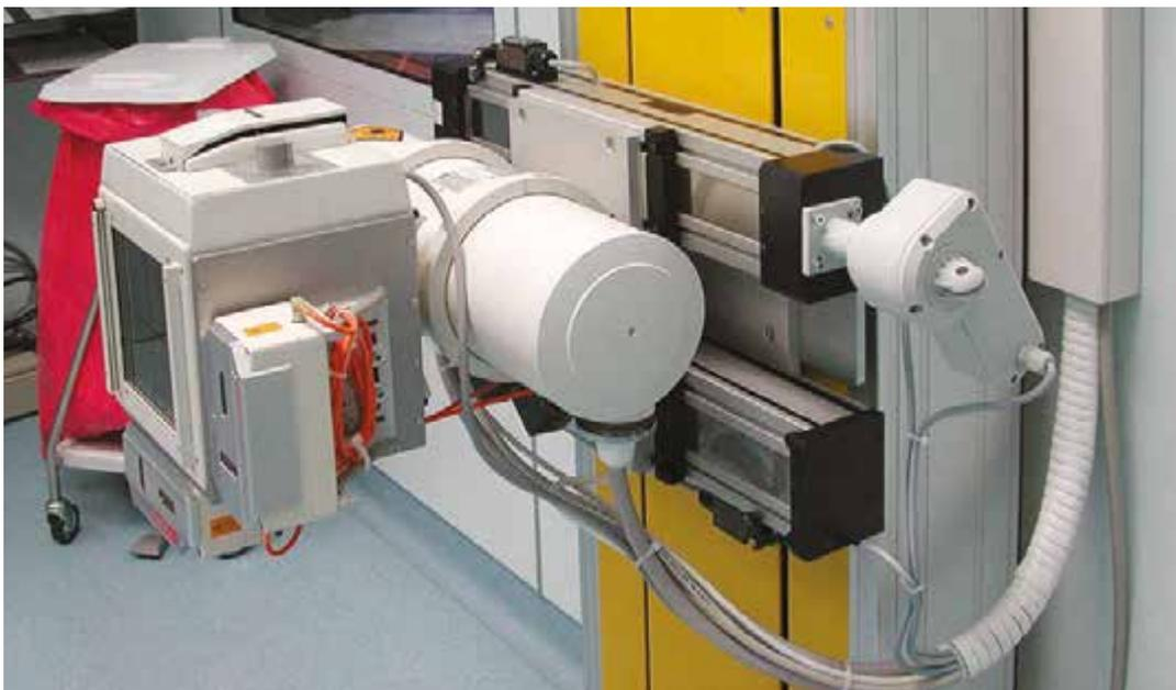
Röntgenkopfverstellung mittels RK DuoLine S
