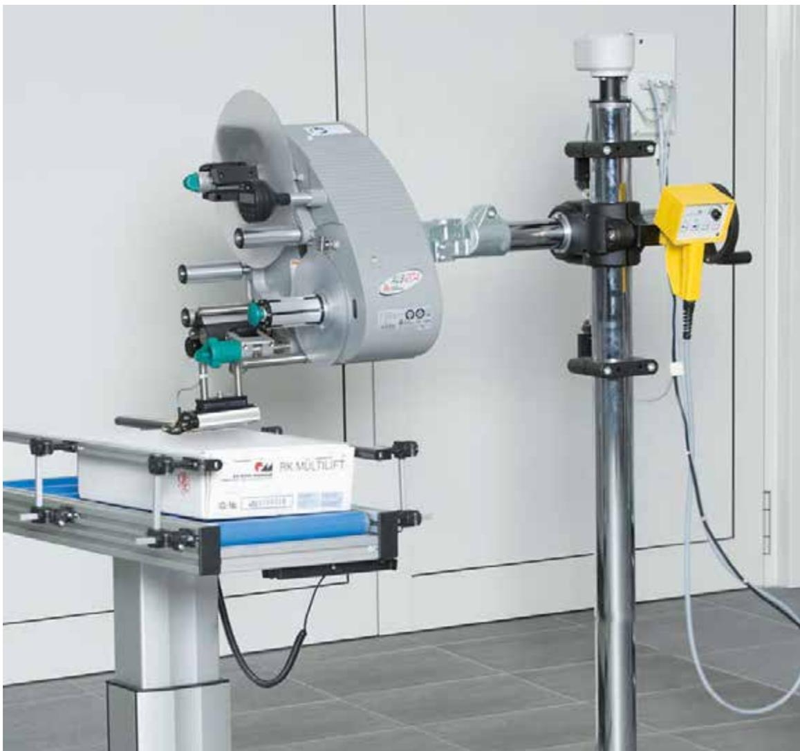
Positionierung eines Etikettierautomaten durch eine kreuzende Rohrsystem Lineareinheit E
