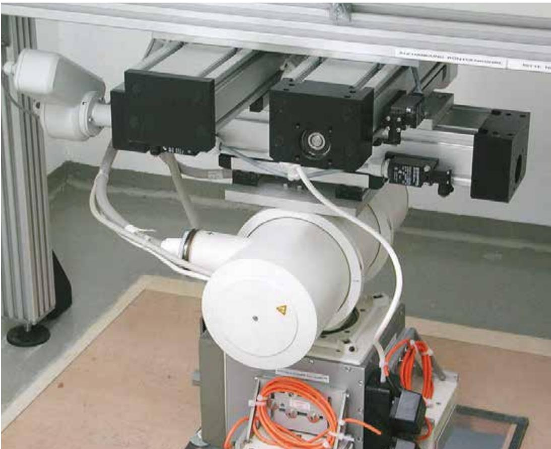
Aufhängung einer Röntgenröhre. X-Y-Verstellung der RK DuoLine S über ein EHL
