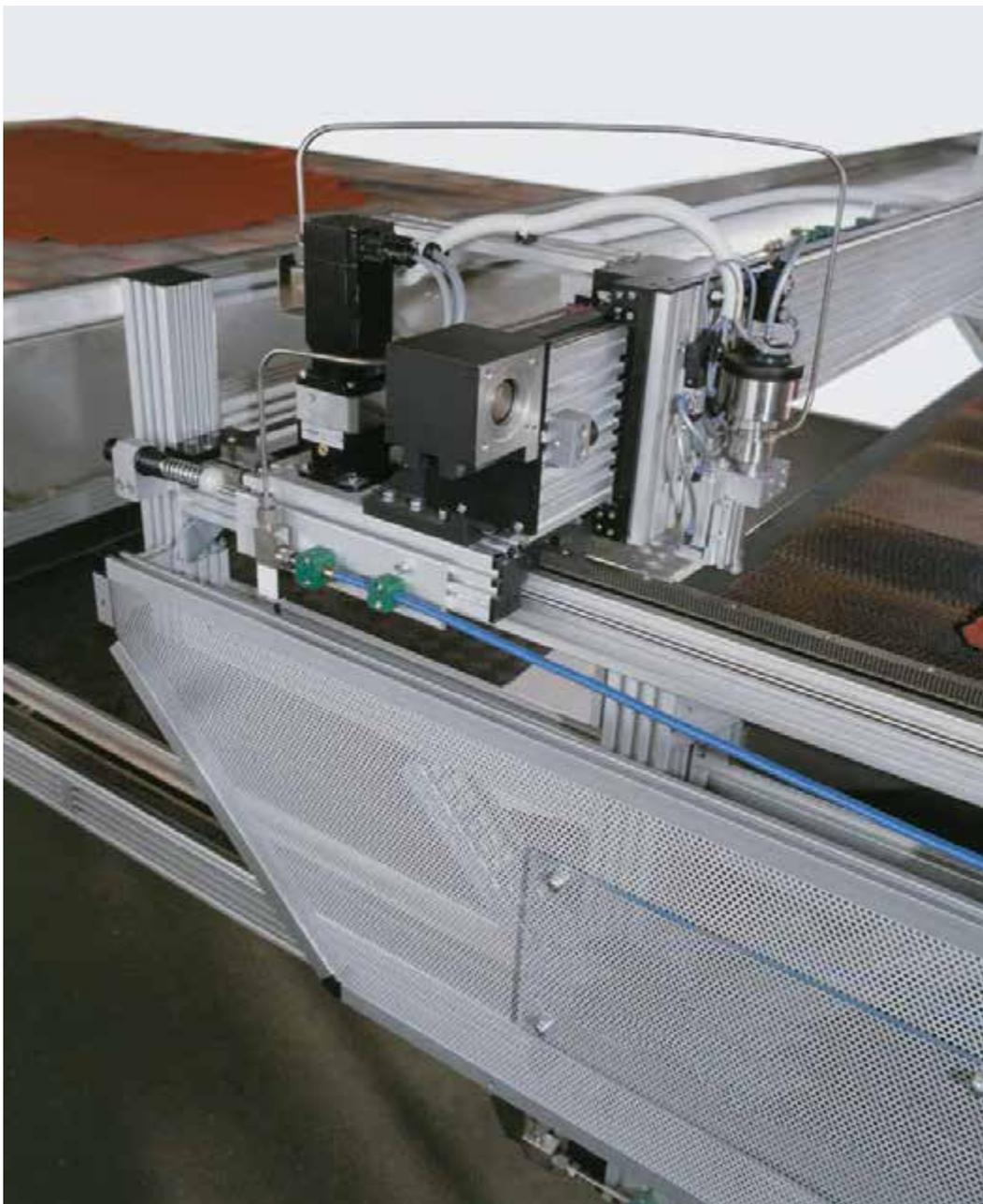
3-Achs-Plotter, X-Achse verfährt über eine Zahnstangeneinheit SQ ZST
